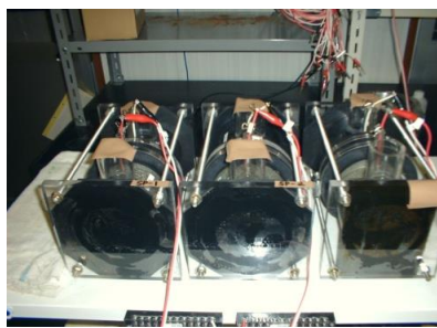
急速塩分イオン浸透試験装置
